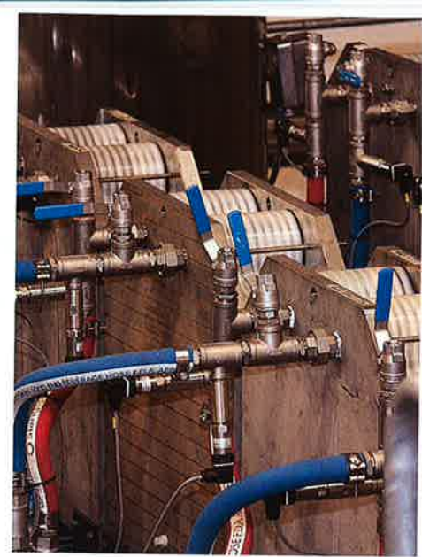
Fig 3: Aquastill module, membraanoppervlakken tot 120 m 2 (links) Fig 4: Vacuum Multi-Effect Membraan Destillatie (V-MEMD) van Memsys (onder) Fig 5: test unit Scarab AB (rechts)
